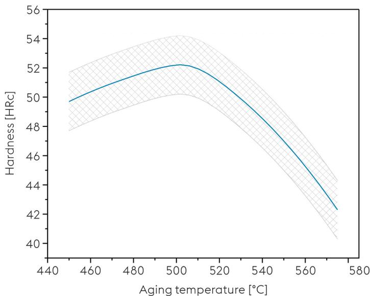
Tratamiento térmico para obtener propiedades óptimas: Recocido por disolución: 1000°C / tiempo de remojo: 1 hora / enfriamiento a temperatura ambiente / Envejecido: 500 °C / tiempo de remojo: 3 horas / enfriamiento al aire
